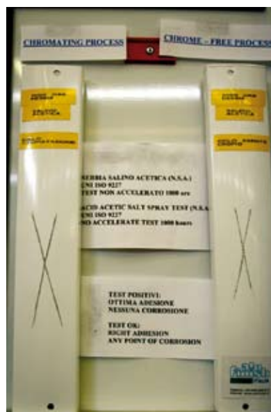
8 - Nella bacheca, all'interno del reparto di verniciatura, sono esposti i risultati comparativi del ciclo tradizionale con cromo e quelli del nuovo ciclo con prodotti "chrome-free" forniti da Alufinish.
